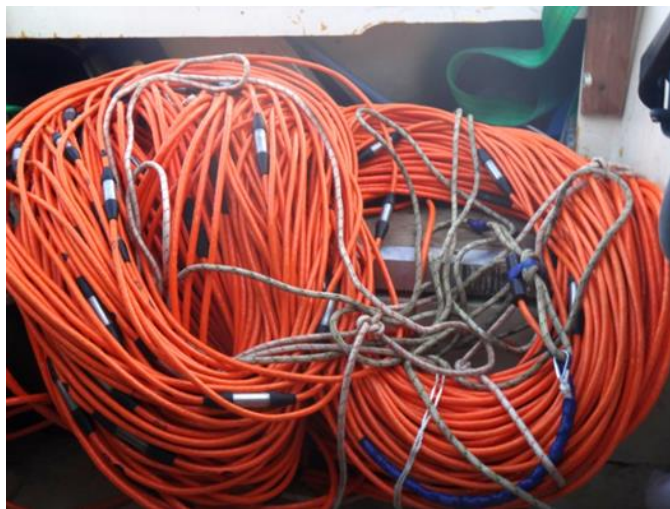
Рисунок 5. Расположение геоэлектрических профилей (слева), и геоэлектрические подводные кабели (справа).
