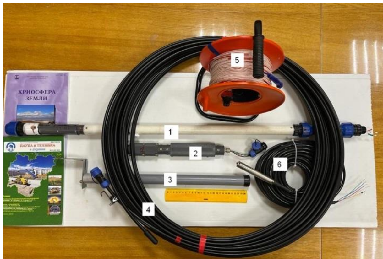
Рисунок 1. 1- сегмент системы контроля углов смещений, 2- логгерное устройство для работы с системой контроля углов смещений, 3- антенное устройство базовой станции LoRa, 4- термометрическая коса, длиной 50 метров, 5- термометрическая коса длиной 100 метров и количеством датчиков 100 штук (без защитной оболочки), 6- пьезометр.
