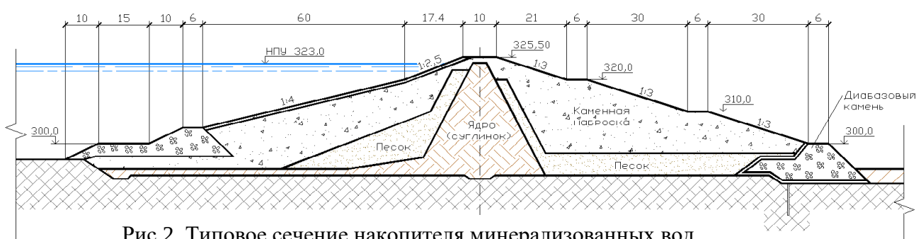
Рис.2. Типовое сечение накопителя минерализованных вод.
