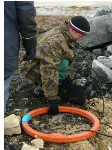
Рис.6. Полевые работы с аппаратурой EM-34 фирмы Geonics.
