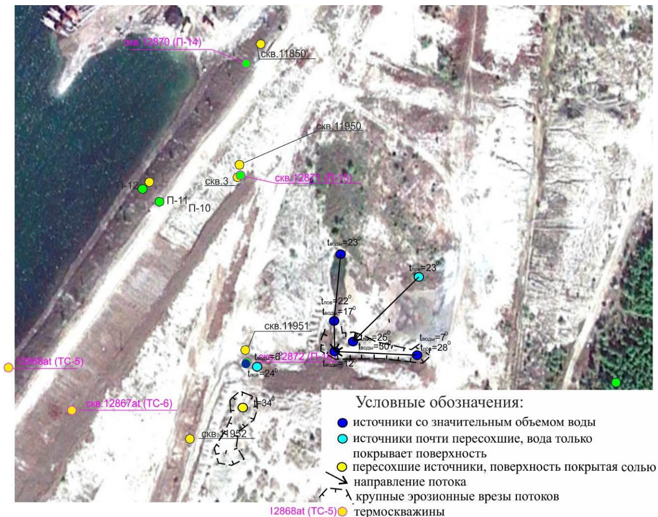
Рис.5. Схема расположения выхода фильтрата и направление их потока.
