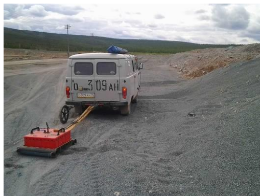
Рис. 9. Автомобильный вариант полевых работ методом георадиолокации.
