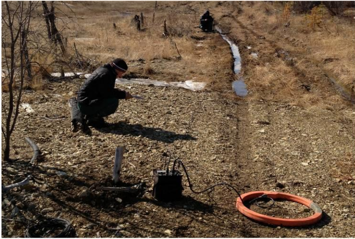
Рис.6. Полевые работы с аппаратурой EM-34 фирмы Geonics.
